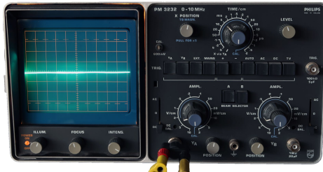
Abb. 2: Gesamtansicht des Oszilloskop ( Y_A auf 0V) und verwendete Einstellungen im Detail
